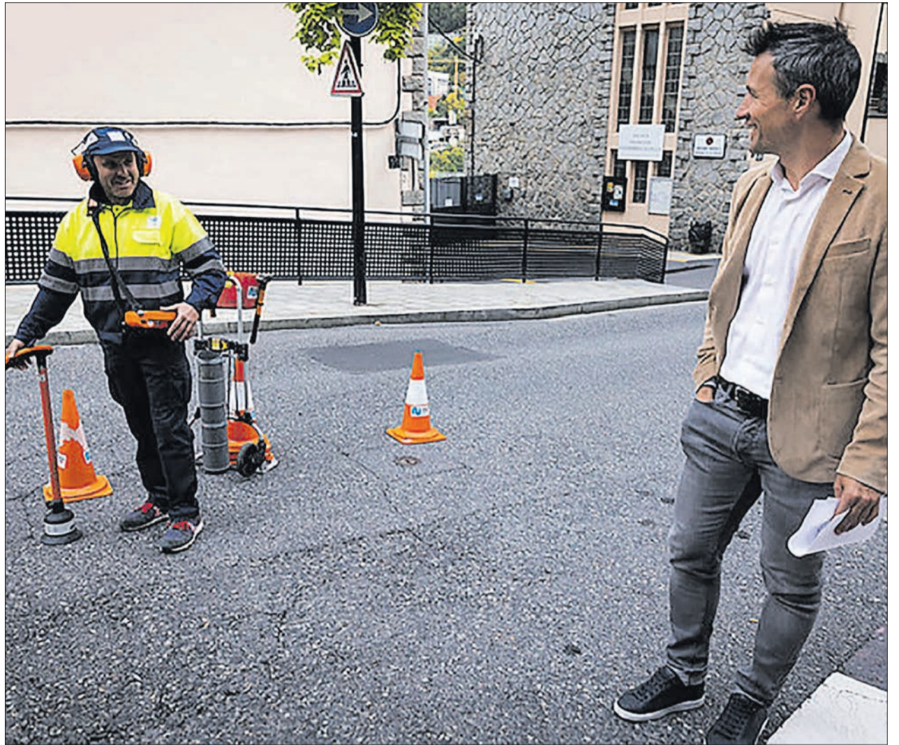
► Un dels tècnics que controlen les fuites a la xarxa d'aigua potable amb David Astrí.
